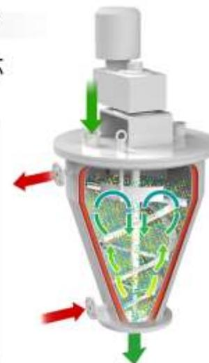
通常、リポコーンにおける加熱処理はジャケットに温水または蒸気を導入して行うものが主流ですが、マイクロ波や熱媒油を利用することで格段に適用範囲が広がり、CO2削減にもつながります。
